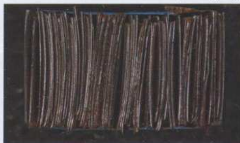
Один из пакетов, сложенный для сварки; структура полосы заготовки для клинка (лезвие справа)
